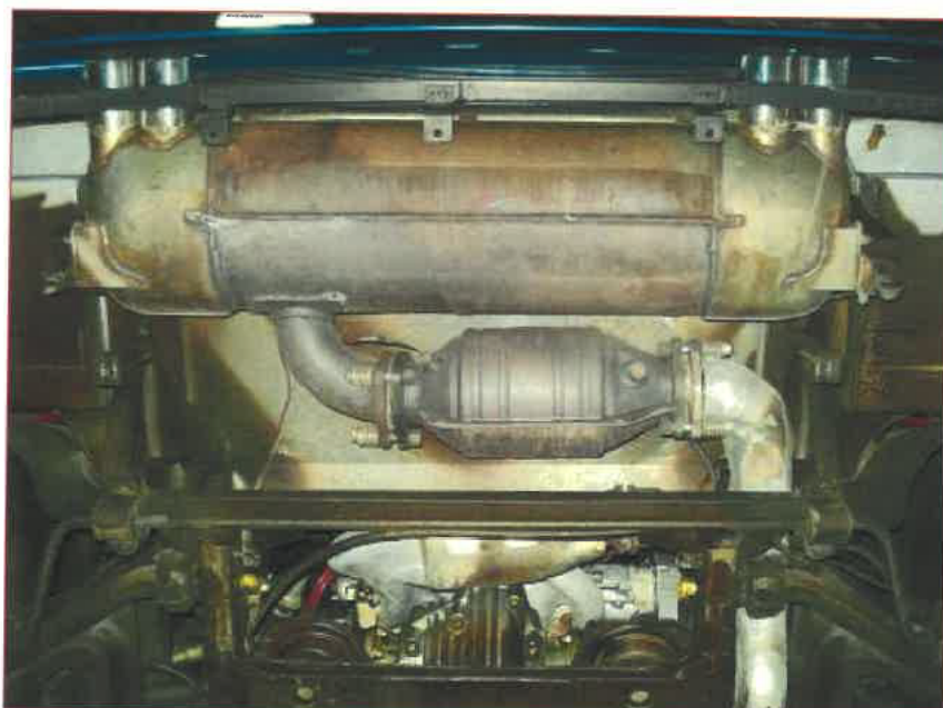
Impianto di scarico Exhaust silencers and outlets
